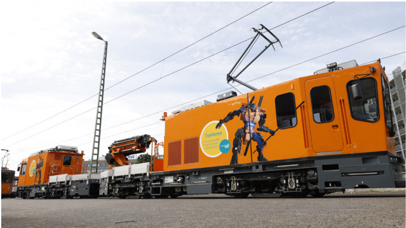
MPV®-VentuS® typ GAF train, vehicle concept with over 50 different modules MPV®-VentuS® Typ GAF Vollbahn, Fahrzeugkonzept mit über 50 verschiedenen Modulen
