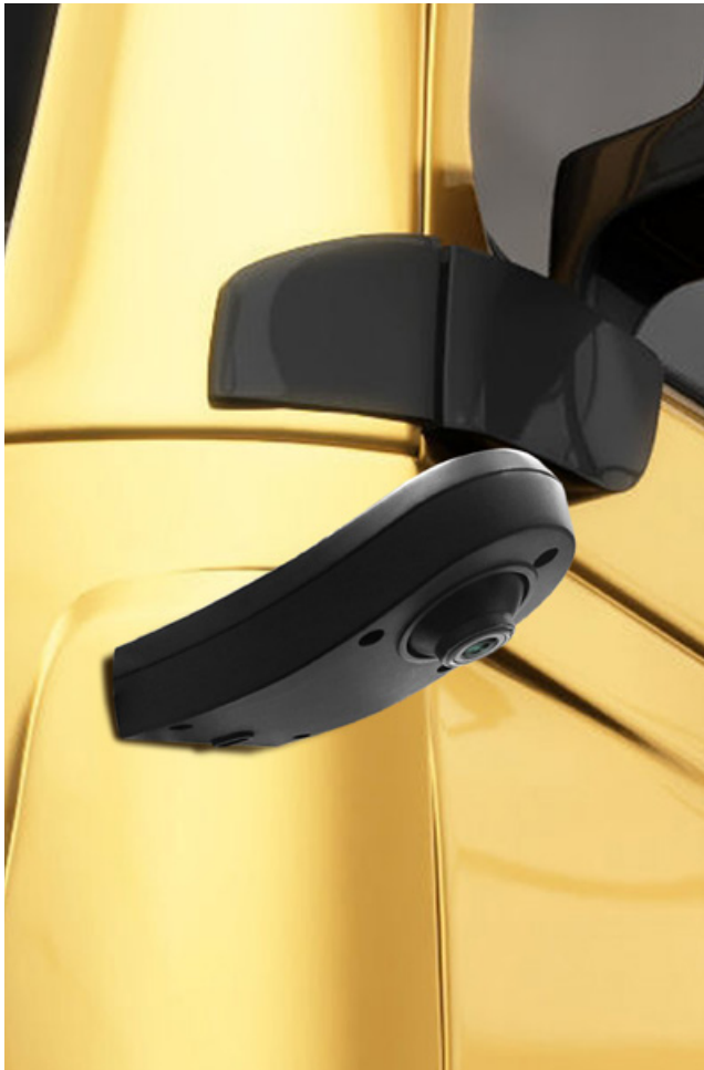
The 270° blind spot camera system for commercial trucks Das 270°-Toterwinkel-Kamerasystem für Nutzfahrzeuge
