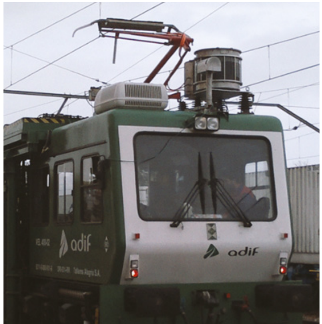
CoPLa-Luber system installed on maintenance vehicle CoPLa-Luber-System in einem Wartungsfahrzeug installiert
