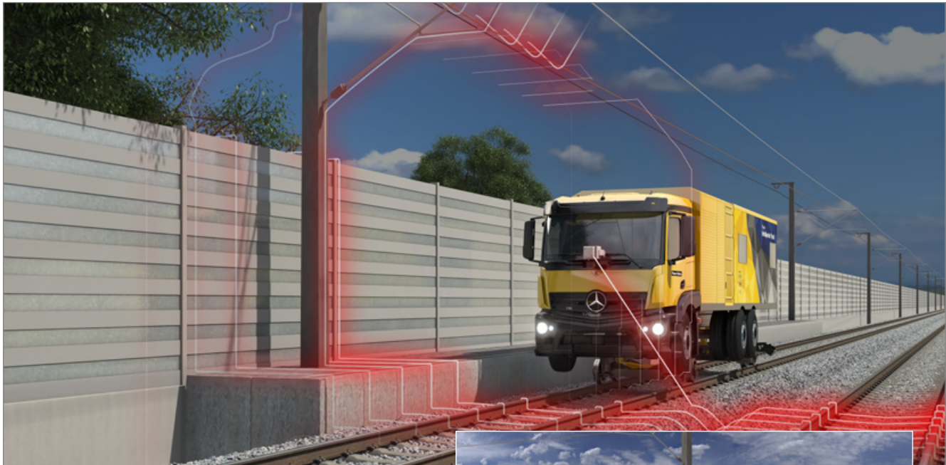
Measuring track, rail, turnout, and overhead contact line Messen von Fahrweg, Schiene, Weiche und Oberleitung
