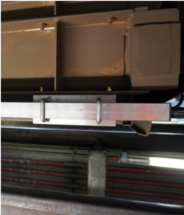
Example installation of an Odomag sensor unit in the underfloor of a Domino vehicle Montage einer ODOMAG Sensoreinheit im Unterflur eines Domino Fahrzeugs
