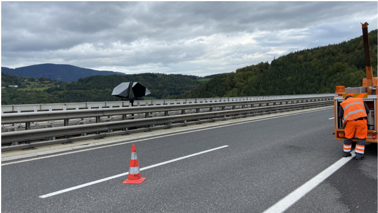
AIT corner reflector for satellite-based bridge monitoring AIT Corner Reflector zum satellitengestützten Brückenmonitoring
