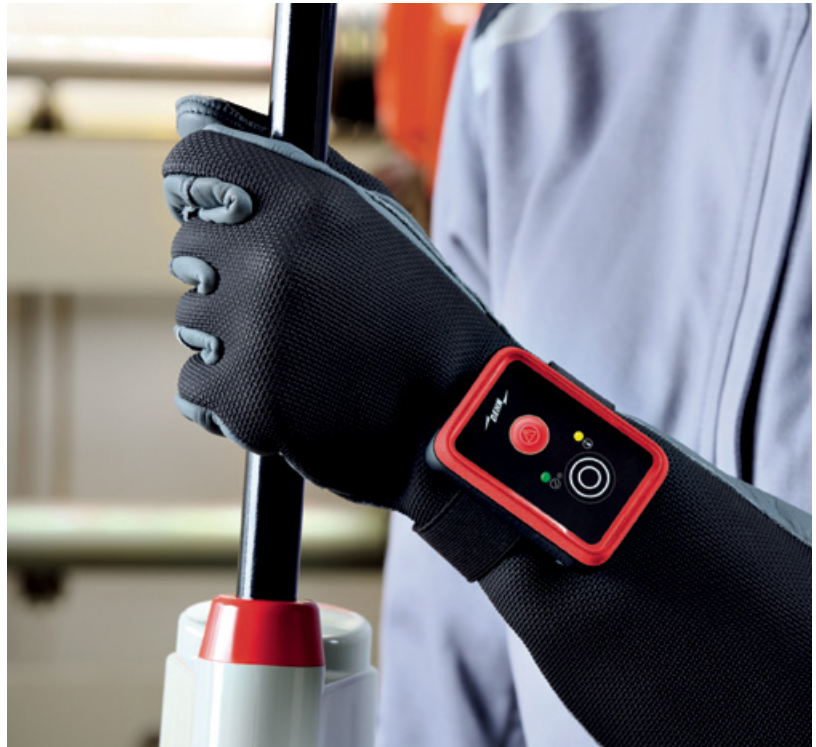
Smart protection for technicians: Site-specific voltage alerts Smarter Schutz für Montagepersonal: anlagenspezifische Warnung vor Spannung
