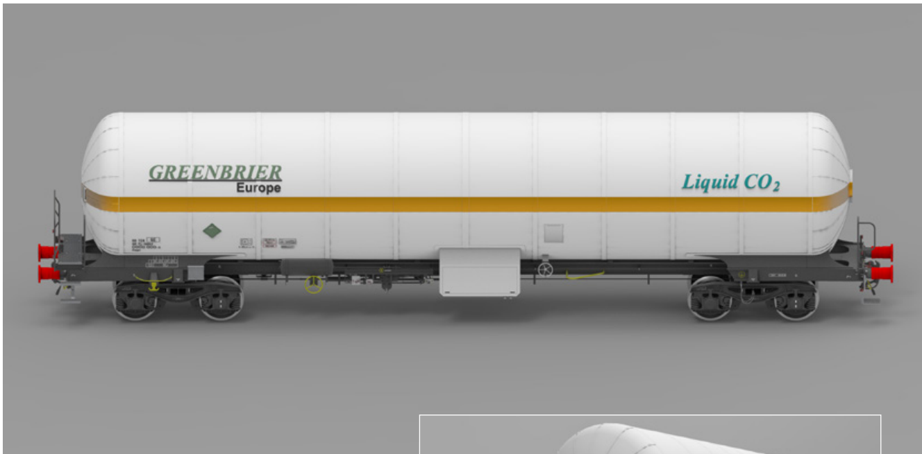
Wagon equipped with crash buffers - ready for DAC Wagen mit Crashpuffern ausgestattet – bereit für DAC
