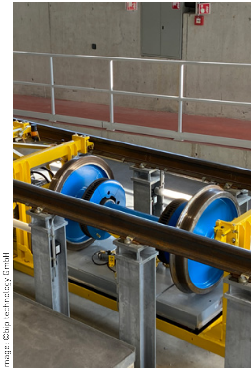
Ultrasonic underfloor testing system in track Ultraschall Unterflurprüfanlage im Gleis
