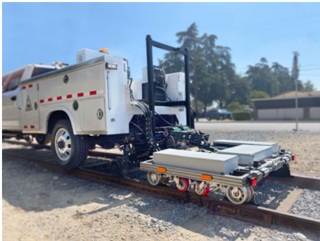
Ultrasonic and eddy current high-speed rail inspection system Ultraschall- und Wirbelstrom-Geschwindigkeitsprüfsystem
