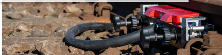
Le compteur d'essieux détecte les trains qui arrivent et transmet le signal à la station de base.
