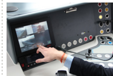
DV-Rec : système de vidéosurveillance embarqué
