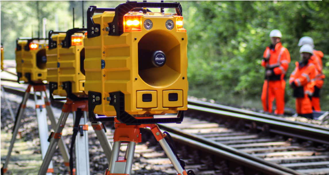
Automatisches Licht- und Tonwarnsystem warnt vor herannahendem Zug
